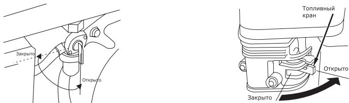
**ВНИМАНИЕ!** Управление топливным краном на разных моделях бензиновых генераторов СКАТ отличается. Смотрите рисунки.
