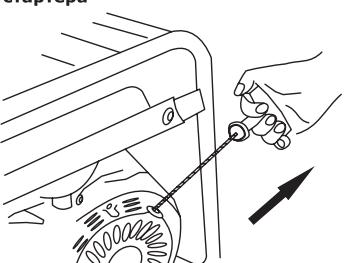
**ВНИМАНИЕ!** Ни в коем случае нельзя производить пуск при работающем двигателе.
