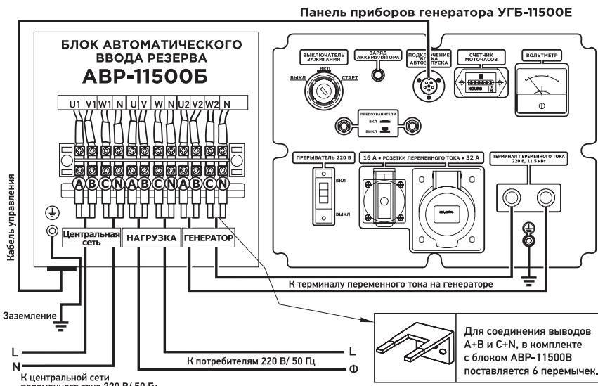
**Рис. 21. Рекомендуемая схема подключения резерва АВР-11500Б (3 ФАЗЫ)**
