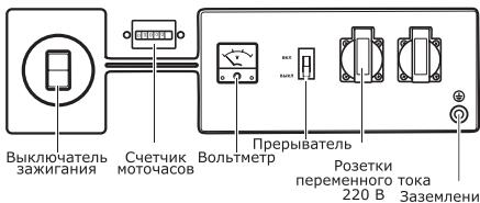
\* — УГБ-4000, УГБ-4000Е, УГБ-5000, 5000Е применяются две розетки на 16 А, на моделях УГБ-6700, УГБ-6700Е, УГБ-7500, УГБ-7500Е УГБ-8200, УГБ-8200Е — одна розетка на 16 А, одна на 32 А
