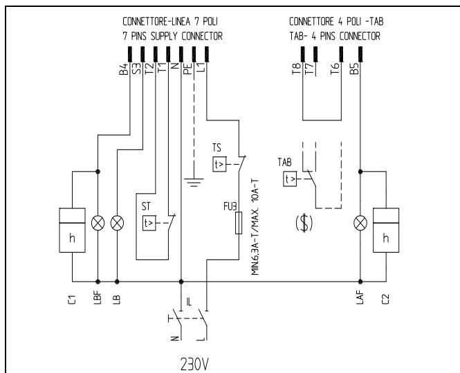
Рис. 7 - 7- и 4-х полюсные соединительные разъемы
