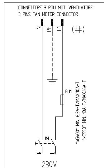
Рис. 8 : 3-х полюсный соединительный разъем электродвигателя
