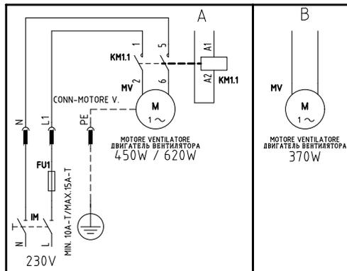
(#) MOTORE VENTIL. 450W O 620W, FU2 = 6,3A F; MOTORE VENTIL. 370W, FU2 = 10A F
