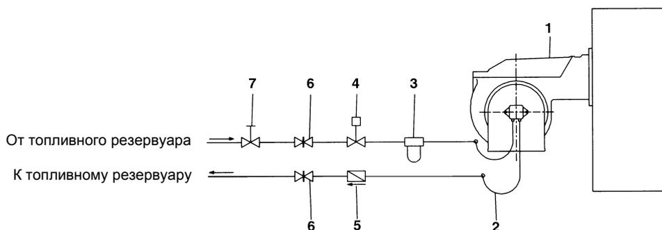
Рис. 9 - Двухтрубная система
