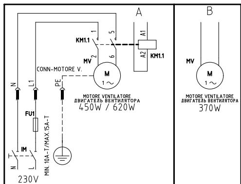
(#) MOTORE VENTIL. 450W 0 620W, FU2 = 6,3A F; MOTORE VENTIL. 370W, FU2 = 10A F
