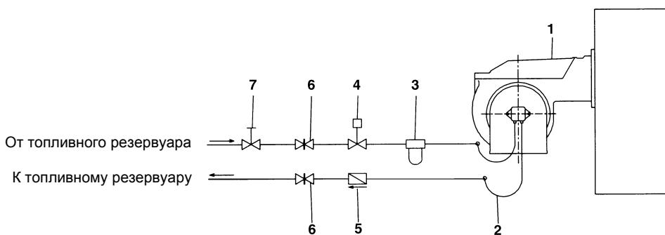
Рис. 9 - Двухтрубная система
