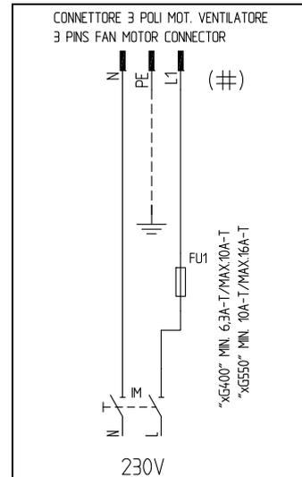
Рис. 8 : 3-х полюсный соединительный разъем электродвигателя
