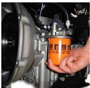
Снимите топливный фильтр и замените его новым
